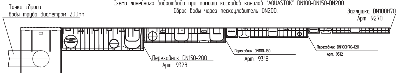
Схема линейного водоотвода при помощи каскадов каналов "AQUASTOK" DN100-DN150-DN200.
